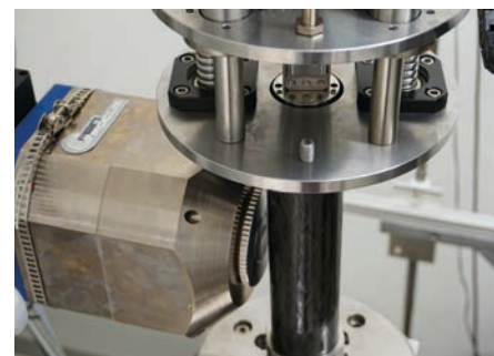
Der Probenaufbau wird von oben in das CFK-Rohr des Prüfaufbaus geschoben.
